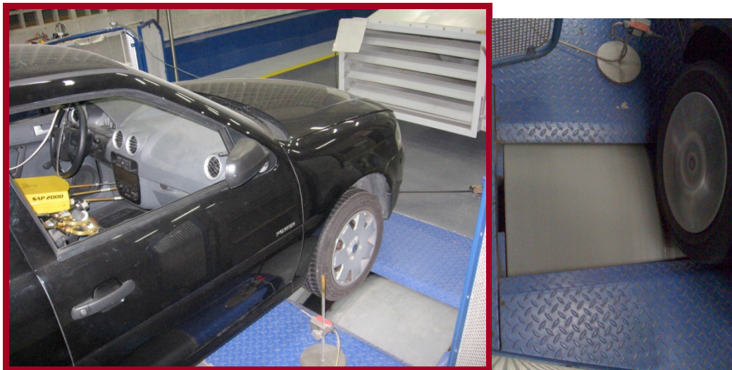
Figura 2 – Dinamômetro usado para medir a potência dissipada pela roda.
